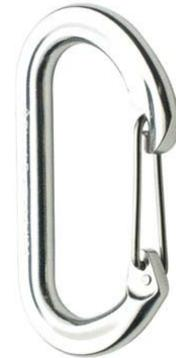
*Fig. 21 Mosquetón sin seguro fabricado en aluminio con gatillo de acero inoxidable (Black Diamond)*
