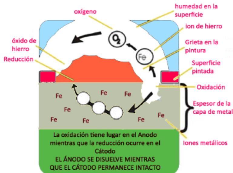
Fig. 18 Representación esquemática del proceso de corrosión del hierro
